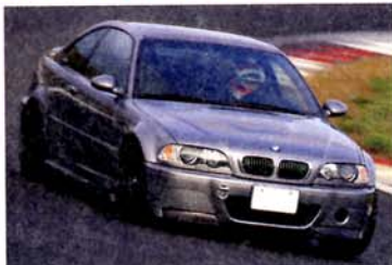
純正モデルに対し約17psエンジン出力を向上し、約110kgもの軽量化を果たした2シーターモデル。CSLはクーペ・スポーツ・ライトウェイトの略である
