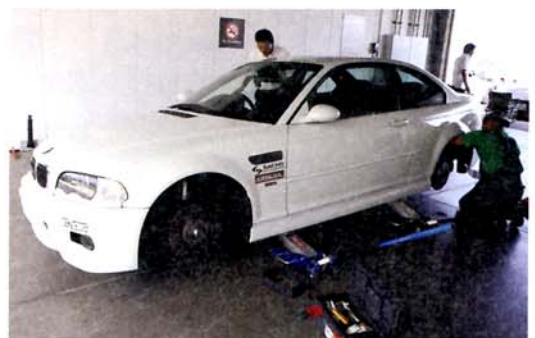
ブレーキディスク/パッド、そして純正サイズタイヤの変更による走行フィーリングや性能の変化を見るために、インターバル中にピットで作業をするガルフストリームの面々。こうした地道な開発が、クオリティの高いパーツを生み出す
